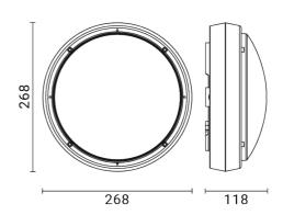
Luminaire d'extérieur pour installation au mur/plafond
