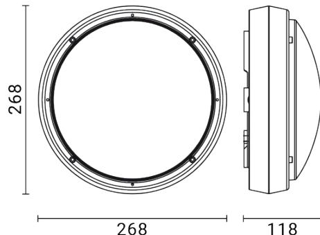
Luminaire d'extérieur pour installation au mur/plafond
