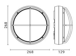
Luminaria de exterior para instalación en pared/techo
