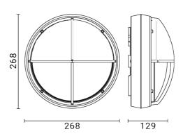
Luminaire d'extérieur pour installation au mur/plafond
