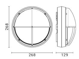
Luminaria de exterior para instalación en pared/techo
