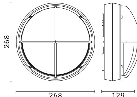
Luminaria de exterior para instalación en pared/techo
