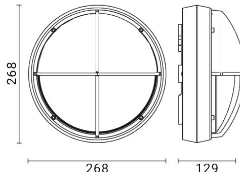
Luminaire d'extérieur pour installation au mur/plafond
