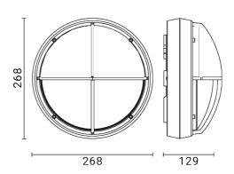
Luminaire d'extérieur pour installation au mur/plafond
