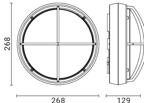
Luminaire d'extérieur pour installation au mur/plafond
