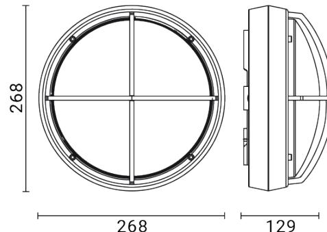
Luminaire d'extérieur pour installation au mur/plafond
