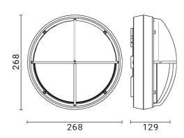
Luminaria de exterior para instalación en pared/techo
