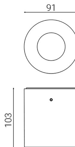
Luminaire d'extérieur pour installation au plafond
