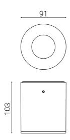
Luminaria de exterior para instalación en techo
