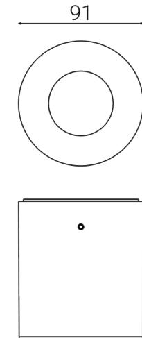
Apparecchio illuminante da esterno per installazione a soffitto
