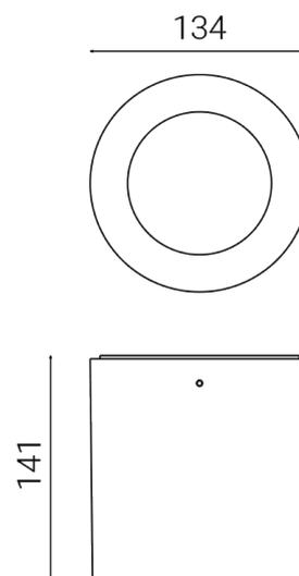
Luminaire d'extérieur pour installation au plafond
