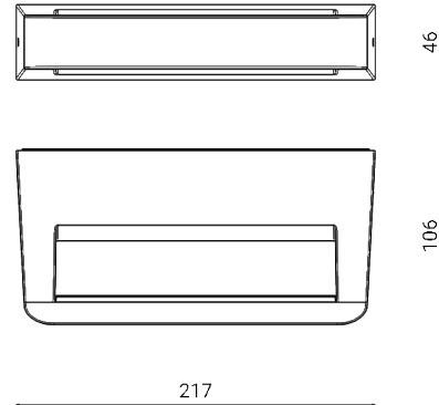
Luminaria de exterior para instalación en pared
